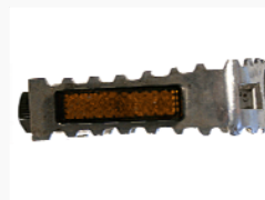
La pédale est liée à son maneton par des roulements suivant une liaison pivot
