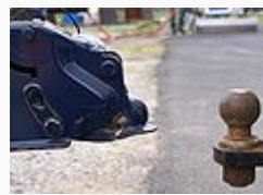
Un attelage de caravane ou de remorque légère est modélisable par une liaison rotule.
