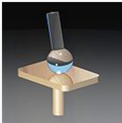
Cas théorique d'une ponctuelle en associant une sphère et un plan
