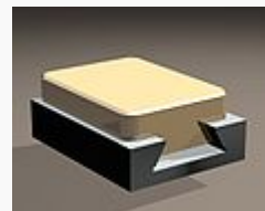
Assemblage en queue d'aronde pour une liaison bilatérale.
